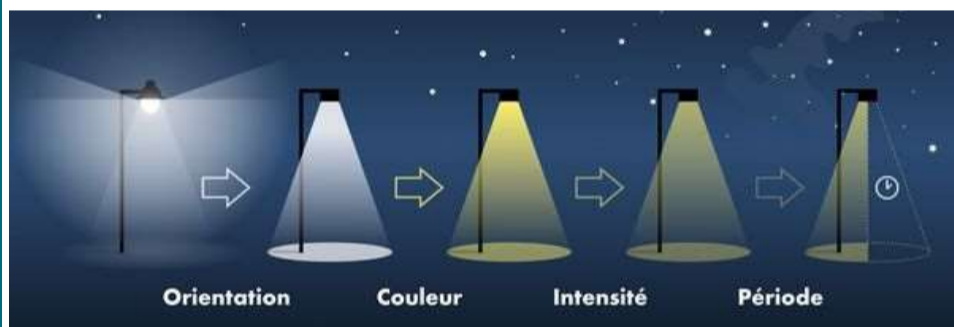
Représentation des quatre critères à prendre en compte pour l'éclairage nocturne (Réserve internationale de ciel étoilé du Mont Mégantic, s.d.)
